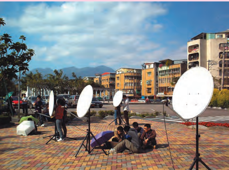
參與動手作活動的學生正在使用自製80公分口徑的電波望遠鏡觀測太陽。
