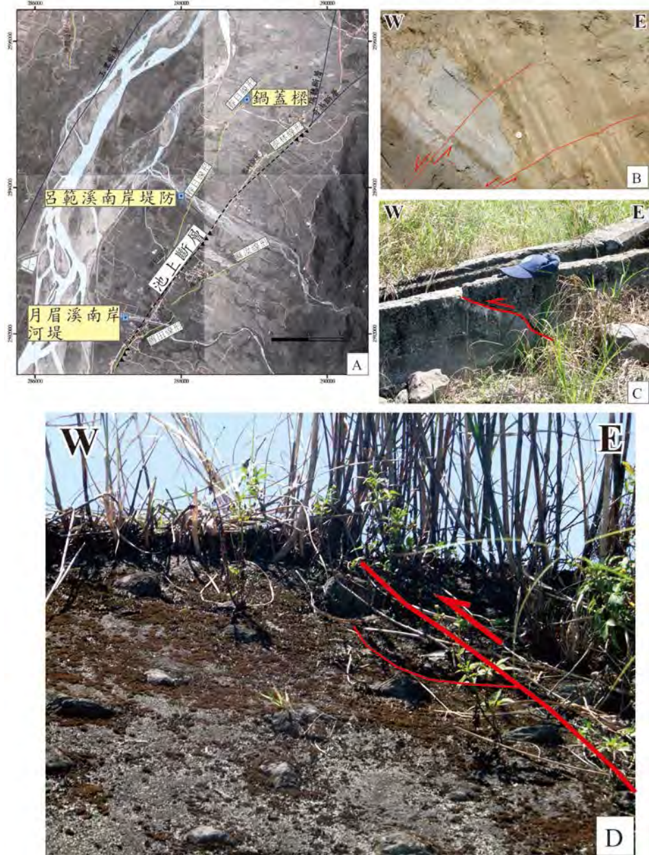
圖二、A：春日至泰林地區地表破裂位置圖。B：鍋蓋樑東南側之露頭，沉積層有向東傾斜的現象。C：呂範溪南岸堤防附近之逆衝破裂。D：月眉溪南岸河堤逆衝破裂。
