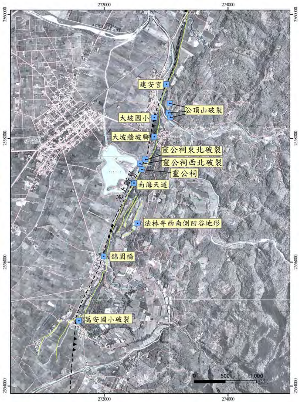
圖八、A：池上至萬安地區地表破裂位置圖，綠色實線為沈淑敏等(2006)所判釋之構造線形。
