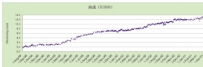
圖七 池上斷層帶上之潛變計及觀測紀錄。上圖為裝置於錦園斷層露頭上之潛變計照片。中間圖為潛變計之機械構造圖。下圖為潛變計所紀錄之三年斷層滑移變化曲線圖。
