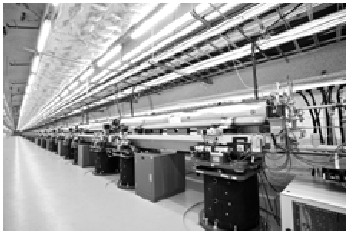
圖六：X光自由電子雷射裝置一隅。美國能源部所屬史丹佛線性加速器中心的國家加速器實驗室，正在進行 X 光自由電子雷射裝置計畫，為了產生超短的 X 光脈衝，他們串聯了十幾個磁鐵陣列才能產生純淨、強大的 X 光自由電子雷射。圖中的裝置為部分串聯起來的磁鐵陣列。
