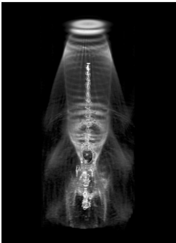
圖五：雷射加速器模擬圖。這是美國勞倫斯柏克萊國家實驗室設計的雷射加速器運作模擬圖，周圍的構造顯示由雷射驅動的電漿波電子分布，中央的亮線顯示被電漿波加速的電子束。
