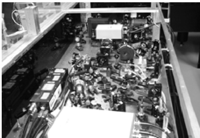
圖三：再生放大器。脈衝可在其中反覆振盪 16 次，放大 200 萬倍。
